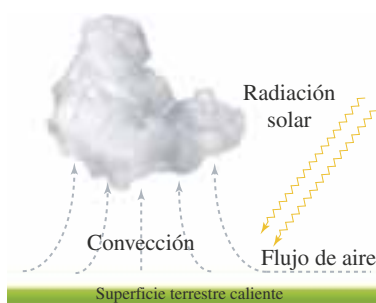
Figura 8. Las corrientes de convección se forman, porque las partículas de aire cercanas a la superficie terrestre se calientan y ascienden.
